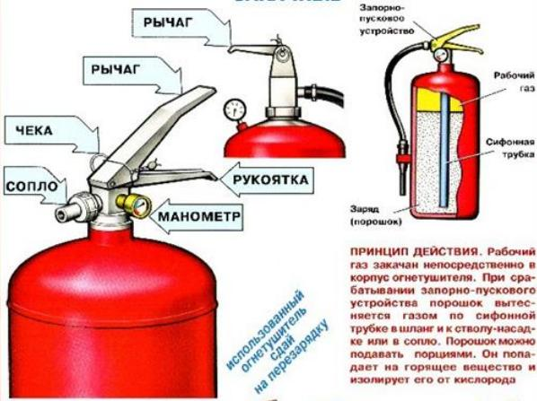
**ПРИНЦИП ДЕЙСТВИЯ.** Рабочий газ закачан непосредственно в корпус огнетушителя. При срабатывании запорно-пускового устройства порошок вытесняется газом по сифонной трубке в шланг и к стволу-насадке или в сопло. Порошок можно подавать порциями. Он попадает на горящее вещество и изолирует его от кислорода
