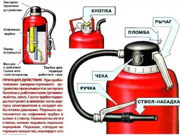
**ПРИНЦИП ДЕЙСТВИЯ.** При срабатывании запорно-пускового устройства проскакиваетается запатка баллона с рабочим газом (углекислый газ, азот). Газ по трубке подводится в нижнюю часть корпуса огнетушителя и создает избыточное давление. Порошок вытекает по сифонной трубке в шланг к стволу. Нажимая на ручку ствола, можно подавать порошок порциями. Порошок, попадая на горящее вещество, изолирует его от кислорода
